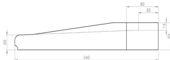
Les éléments 1 et 2 formant le seuil, doivent être du même lot et de même date de fabrication.
