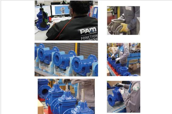
Les vannes EURO 20 sont conçues et testées dans notre CRD à Pont-à-Mousson, usinées, grenillées et revêtues, assemblées et testées unitairement dans notre usine de TOUL.
