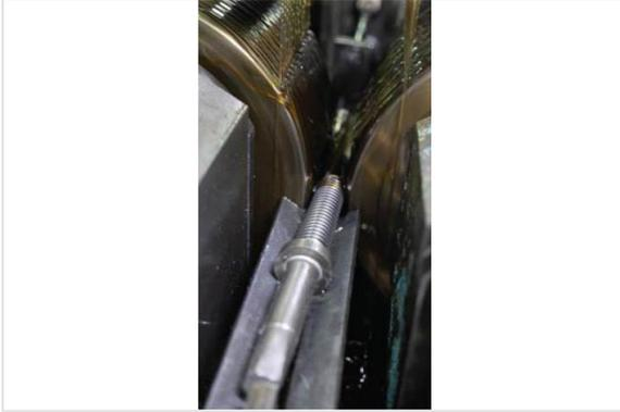
La ligne de fabrication de la vis forgée à froid développée par SG Pam est placée à l'usine de Toul.
