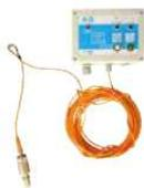
Alarme sonore et / ou visuelle 230 V pour séparateur de graisses permettant de signaler un niveau de graisses dans le séparateur avant saturation. Elle détecte également une absence de remise en eau (possible après les opérations de vidange). Equipée d'un coffret de contrôle IP67 et d'une sonde capacitive IP68/IP69K avec 10 m de câble.
