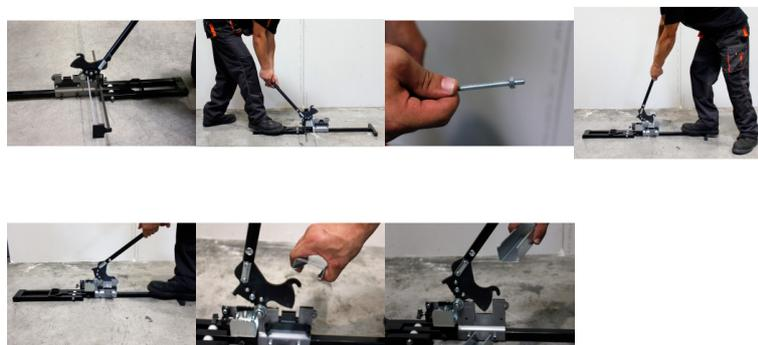
Permet de couper les rails et montants de 48 mm, fourrures F530, tiges filetées M6 et fils d'acier Ø 4 mm.
