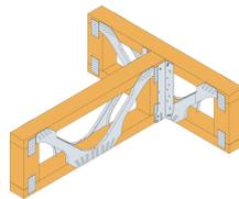
*Fixation sur une poutre métallique ajourée*
