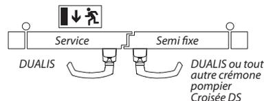
Les deux vantaux sont déclarés issues de secours sous réserve que la manoeuvre de la fermeture d'urgence entraîne l'ouverture du vantail de service et du vantail semi-fixe.
