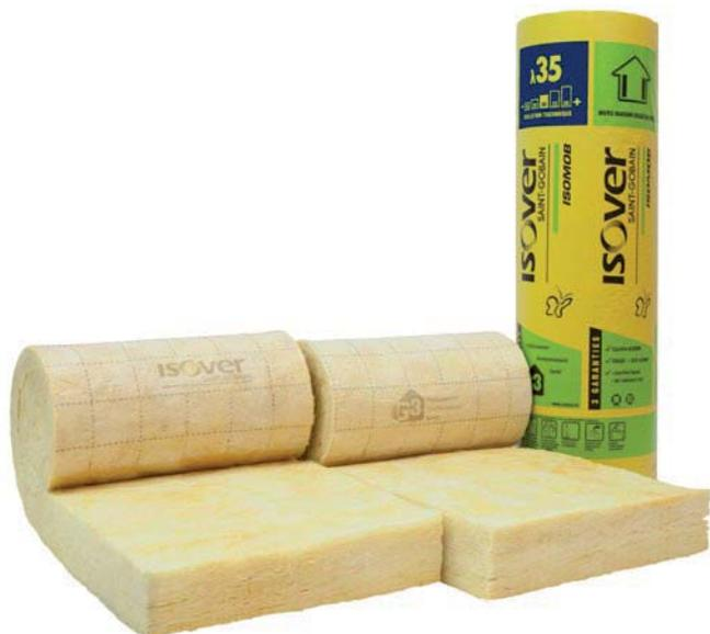
Rouleau semi-rigide en laine de verre à dérouler revêtu d'un voile confort. Prédécoupé aux largeurs standards des entraxes des murs de MOB, il s'intègre sans découpe entre les bois d'ossature.
