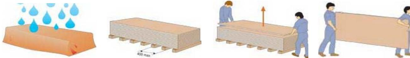
Les plaques sont emballées sur des palettes. Le transport doit être effectué sous bâche. Les plaques doivent être empilées horizontalement sur une surface plane dans un espace sec et ventilé. Les plaques doivent toujours être suffisamment soutenues afin de ne pas fléchir. Si les plaques sont stockées à l'extérieur, elles doivent toujours être protégées de la pluie au moyen d'une bâche ou une
