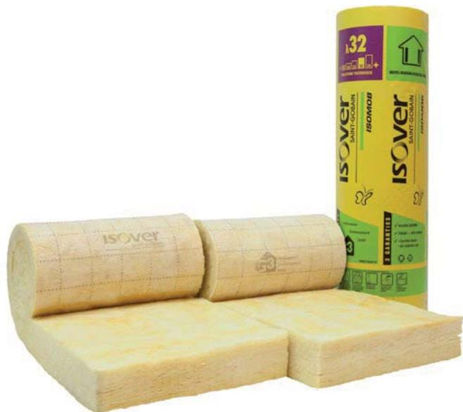
Rouleau semi-rigide en laine de verre, revêtu d'un voile confort. Prédécoupé à une largeur spécialement étudiée pour les entraxes de 0,6 m des murs à ossature bois, il s'intègre sans découpe entre les bois d'ossature.
