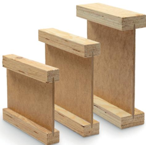
**INOJOIST** | Destinées aux planchers, toitures terrasses, chevrons porteurs et murs ossature bois, les poutres en I Inojoist sont constituées d'une âme hardboard 8 mm et de membrures lamibois.
