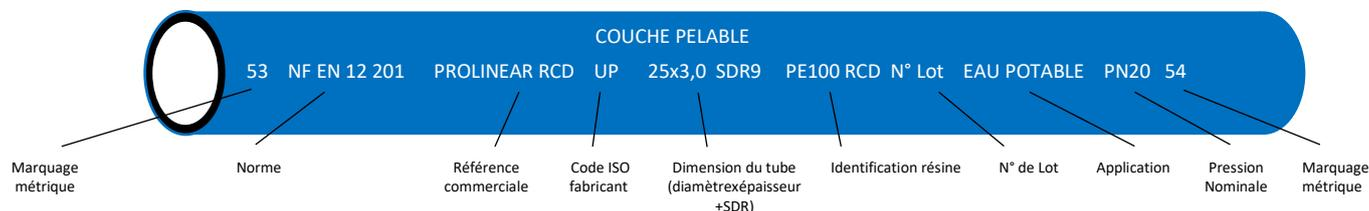
Contrairement à un tube uniquement conforme à la norme NF EN 12 201, un tube certifié à la Marque NF114 est fabriqué avec une matière 100% vierge de façon certaine et possède un marquage gravé à chaud sur le tube avec notamment les codes de traçabilité internationaux ISO du fabricant et de la matière première. L'interprétation de ces codes est disponible sur le site : [www.traccoding.com](http://www.traccoding.com).
