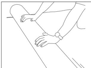
1• Dérouler la sous-couche isolante avec polyane (ex : ISOL 30) sur le support plan et sec. Les lés sont scotchés entre eux bord à bord et remontent jusqu'au pied des plinthes.
