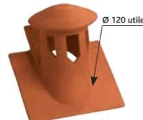
Tuile à douille ø 120 utile + lanterne incorporée (section d'aération : 80 cm<sup>2</sup>) Réf. 501.31 (1)
