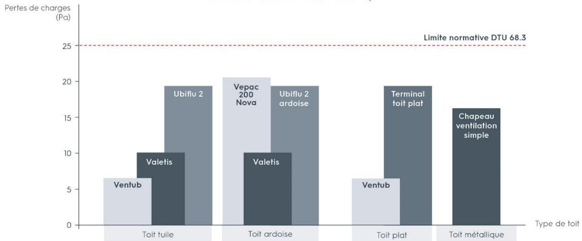
Les pertes de charge sont exprimées en **pression totale** (pression statique + pression dynamique).
