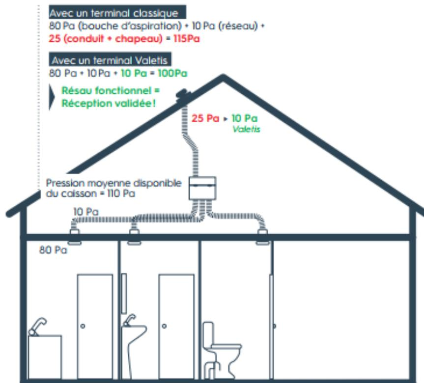
\*Un conduit de rejet classique (ex. conduit souple) peut générer à lui seul jusqu'à 15 Pa de pertes de charge, ce qui laisse 10 Pa de pertes de charge maximum autorisées pour le chapeau de toiture pour être conforme DTU 68.3 (25 Pa max réseau de rejet + chapeau compris).
