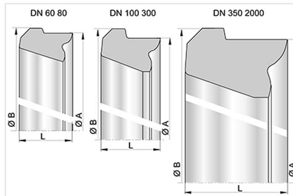
La bague de joint STANDARD est compatible avec l'ensemble des emboîtures STANDARD de tuyaux et raccords des gammes pour l'eau et l'irrigation.
