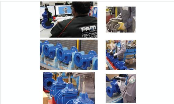
Les vannes EURO 20 sont conçues et testées dans notre CRD à Pont-à-Mousson, usinées, grenillées et revêtues, assemblées et testées unitairement dans notre usine de TOUL.
