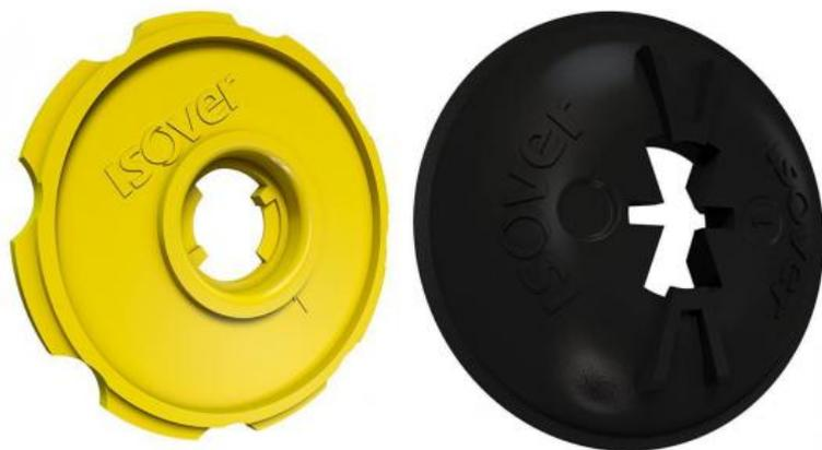
Pièce composée de deux parties :- Une rondelle jaune en polymère rigide verrouillable par quart de tour sur l'appui Optima 2.- Une rondelle élastique noire assurant le pincement de la membrane Vario® dans le système de doublage Optima Murs.
