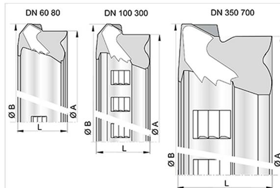
La bague de joint verrouillé STANDARD Vi (à inserts) est de géométrie identique à celle de la bague de joint STANDARD, se logeant dans la même emboîture, la bague STANDARD Vi comporte en plus des inserts métalliques qui viennent s'accrocher sur le bout-uni du tuyau (ou du raccord) adjacent, après montage.
