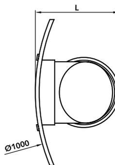
Les écarts indiqués dans le tableau sont nécessaires pour les différentes variantes : par exemple, pour le Funke-ILA 160, l'écart est seulement de 217 mm par rapport à la paroi du regard. Grâce à cela, le regard est toujours accessible.
