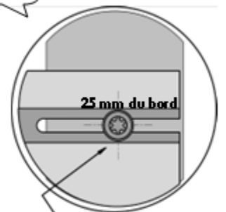
Fixation correcte permettant la dilatation
