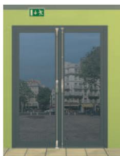
Les crémones "DÉESSE" permettent de condamner le vantail semi-fixe d'une porte à 2 vantaux dont le vantail de service peut être déclaré "issue de secours" (pour des raisons de sécurité, il est important de s'assurer que le verrouillage du vantail semi-fixe n'entrave en aucun cas le fonctionnement du vantail de service).
