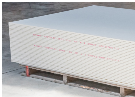
Plaques Knauf HydroProof® sur chantier
