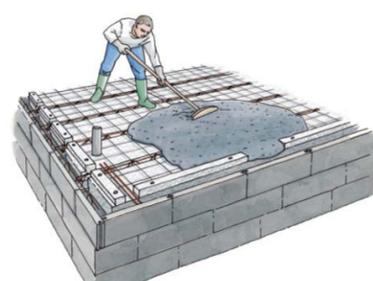
**Etape 5 :** Pose des armatures et coulage de la dalle de compression
