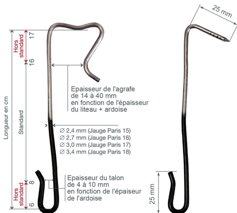
Conformément au DTU 40.11, les crochets dont la longueur est supérieure ou égale à 12 cm sont automatiquement livrés en crosinus.
