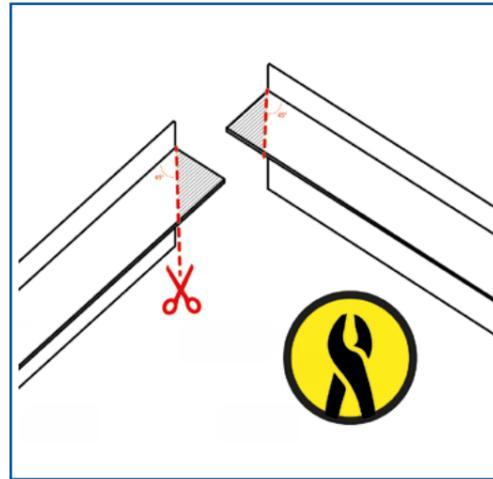
› Placer l'angle sur le profilé. Pré-plier légèrement les rebords de l'angle.
