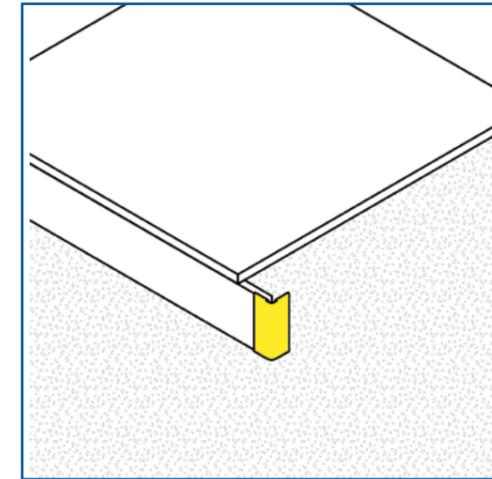
› Le positionner avec un léger retrait pour pouvoir placer le 2<sup>nd</sup> profilé plus facilement.
