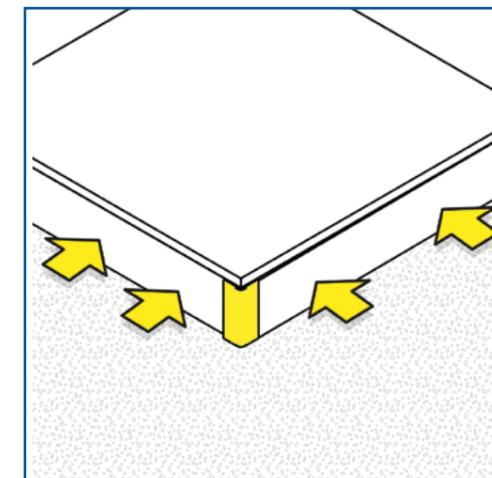
› Terminer la pose en clipsant fort l'ensemble de l'installation.
