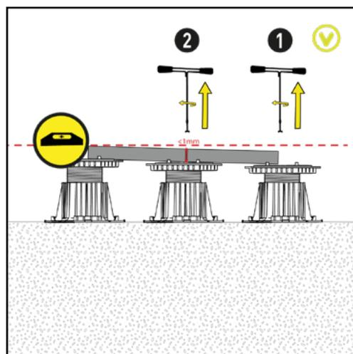
*Dans ce cas de figure, ajuster la hauteur par le plot du milieu.*
