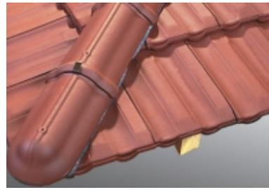
Arêtiers et about d'arétier 1/2 rond à emboîtement grand modèle posés à sec avec closoirs d'arétier gauches et droits «cassons», sans emploi de mortier.
